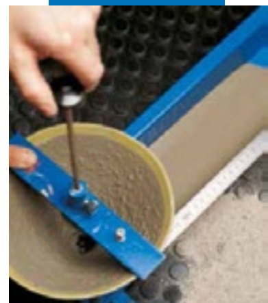
Испытание расширения в канавке согласно норме UNI 8997/89
